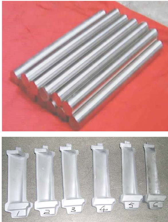
图3 GH4413热轧棒材及模锻叶片毛坯件
