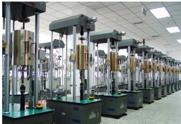
图1 中科院金属所的高温合金材料制备设备及持久蠕变试验机
